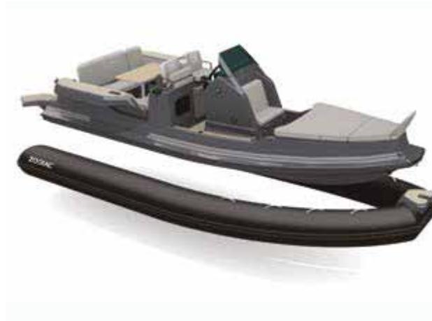
Disponible sur la plupart de ses modèles, le flotteur est équipé d'une ralingue qui s'engage dans une gorge solidaire à la coque. L'étanchéité est assurée par la mise en pression du flotteur.
